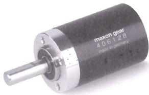
Das neu entwickelte Planetengetriebe GP 16 C überträgt bei Dauerbelastung bis zu 600 Nm und kurzzeitig bis zu 1 Nm. Das sind gegenüber der bisherigen Ausführung doppelte Werte, die in erster Linie dank Keramikachsen erreicht werden.
