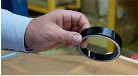
Das von AHC Oberflächentechnik im Duralloy-Verfahren veredelte Metalloberflächen mit Micro-Perlstruktur. (Bild: AHC)
