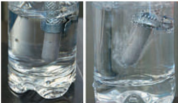
Von BSF Bünter additiv hergestelltes Metallteil, das von innen nach aussen Druckluft passieren lässt. (Bild: BSF)
