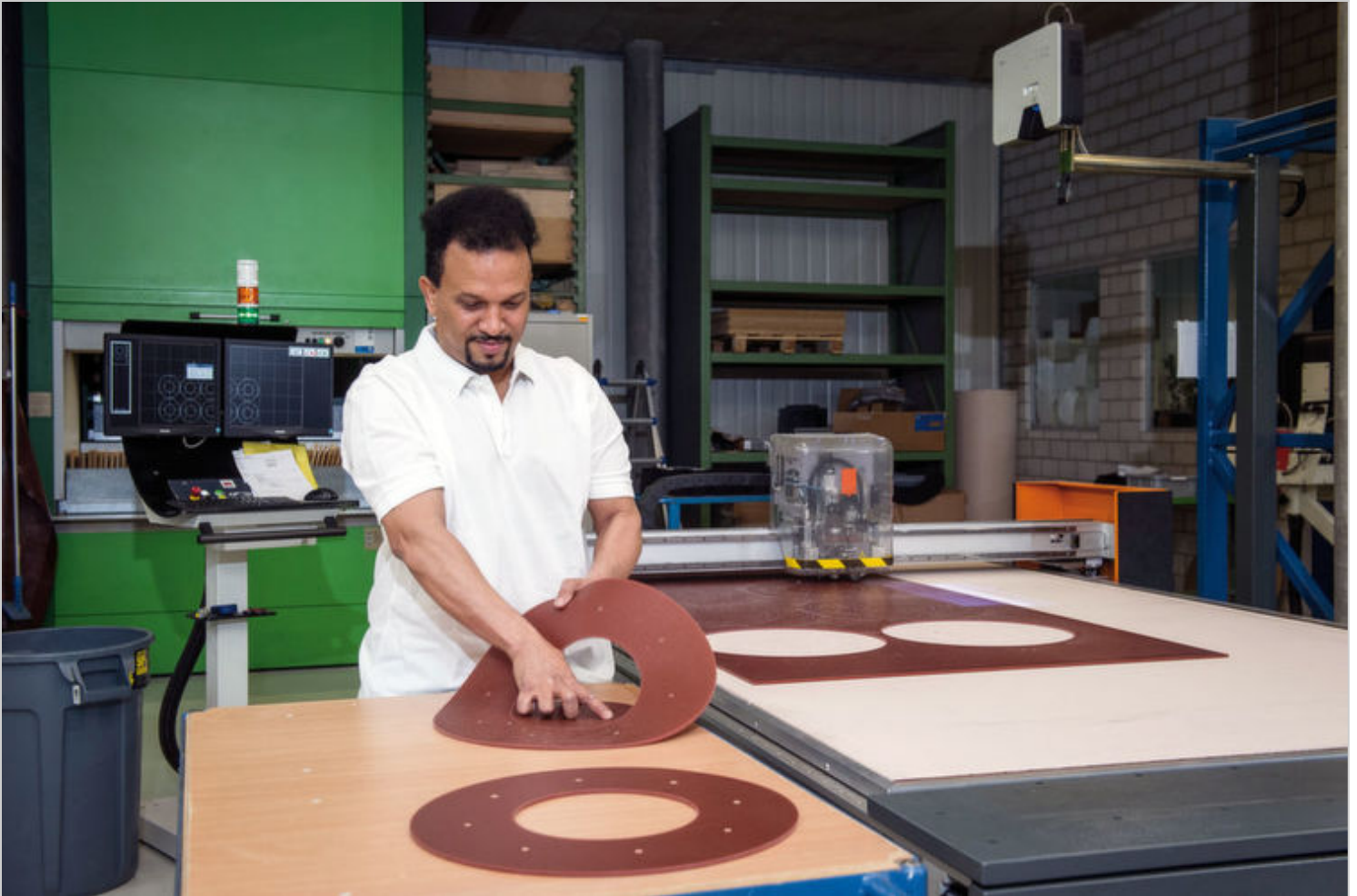
Individuell CNC-geschnittene Flachdichtungen aus Metall, Graphit, Elastomere, Thermoplaste und Faserverbundmaterialien. (Thomas Entzeroth)
