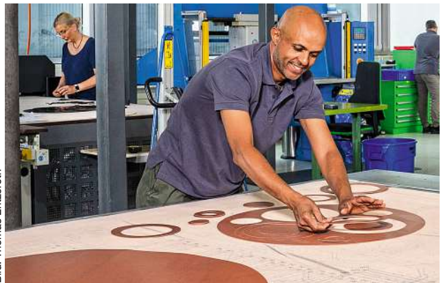
Bis zu drei Millionen Flachdichtungen in allen gängigen Materialien werden kundenspezifisch ab Losgrösse 1 bis 50000 hergestellt.
