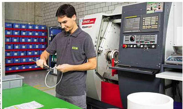
Wellendichtringe oder Rund-Dichtungen können auch per CNC-Drehverfahren individuell hergestellt werden. Auch in diesem Segment verfügt Kubo Tech über eine enorme Bandbreite an Materialien.
